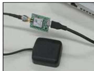
写真-1 RTK-GPSモジュール
