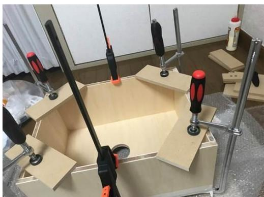
図2 バフルと側板、底板、天板の接着
