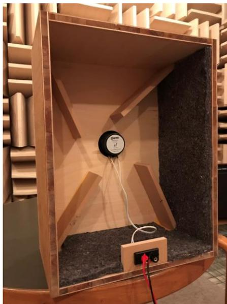
図3 裏面の補強と吸音材の様子
