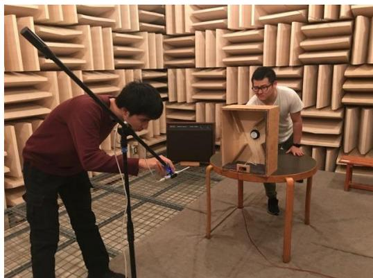
図 6 無響室での特性測定(測定用マイクロホンの調整)
