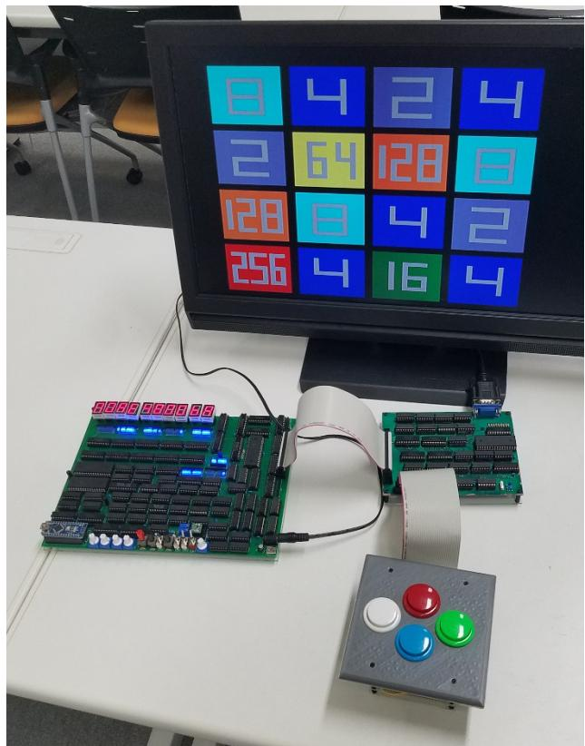
図 10 完成したオリジナル CPU と入出力機器
