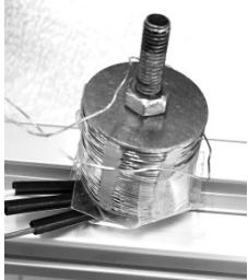
図 24 電磁石の外観
